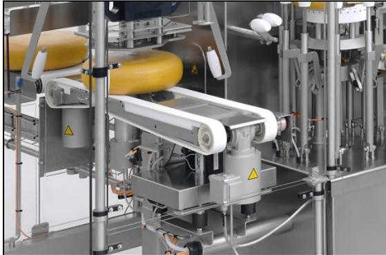
**Abbildung 1: Der komplette Käselaiab wird der Maschine zugeführt**
