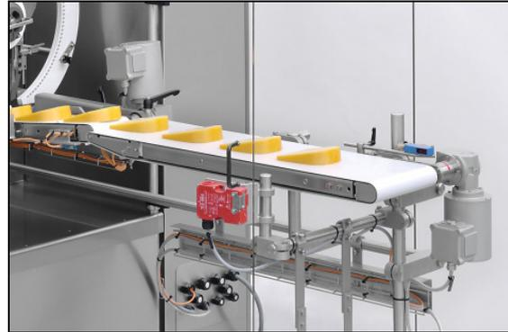
**Abbildung 2: Die geschnittenen Käseportionen verlassen die Maschine**
